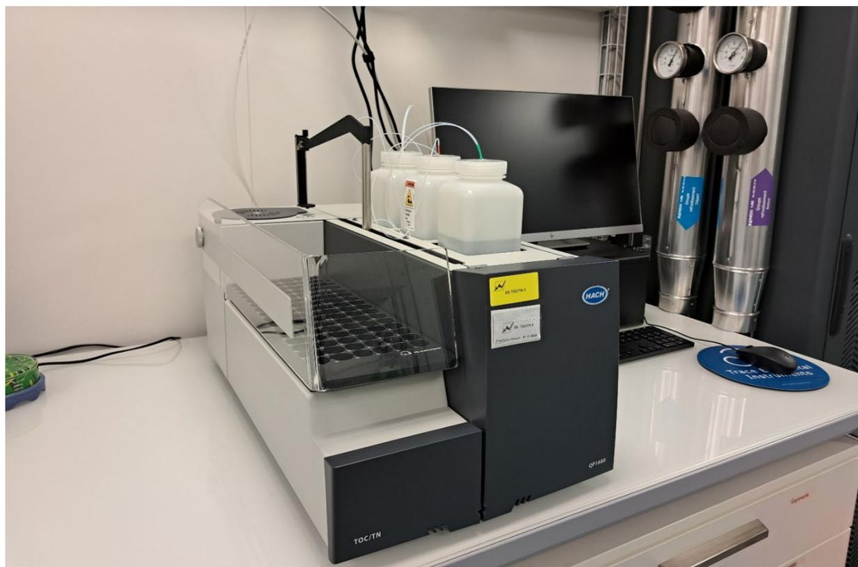
Gerät zur Messung der Gesamtstickstofffrachten. © AfU
