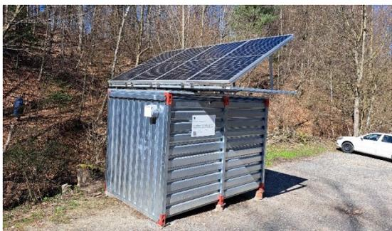
Es wurden 3 automatische Probenehmer installiert, die kontinuierlich Stichproben aus den Gewässern der 3 Einzugsgebiete in Belfaux und Düdingen erheben. Diese Geräte sind zur sicheren Lagerung der entnommenen Proben gekühlt. Messstation von Düdingen. © AfU
