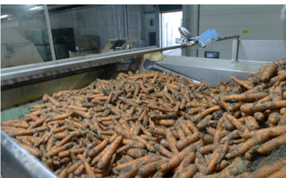
Abbildung 17: Mit Schmutz behaftete Karotten sorgen beim Prozess Rüsten für erdhaltige Abwässer.
