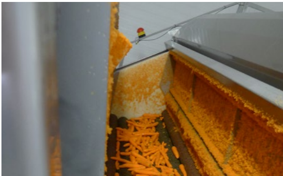
Abbildung 12: Maschinelles Schälen (links Karotten) versus manuell zu schälender Kohl (rechts)
