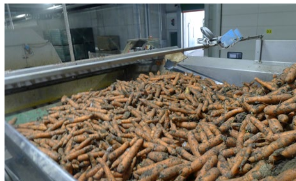
Abbildung 8: Auf dem Rüttelband werden die Karotten enterdet.
