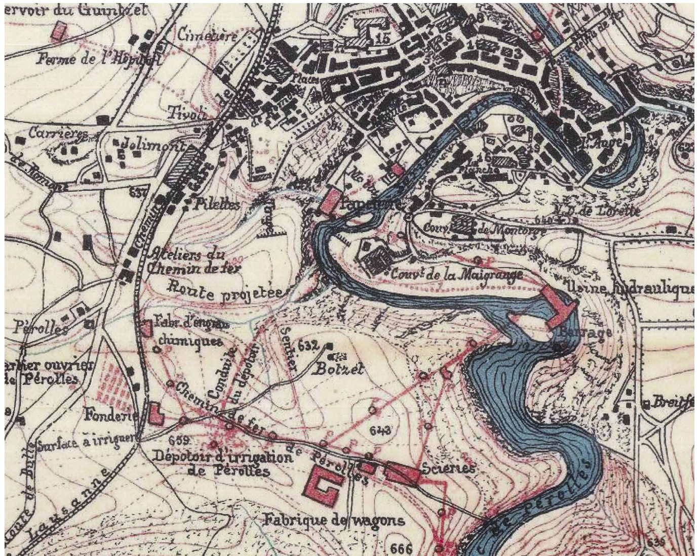
Plan der Stadt Freiburg aus dem Jahr 1875. Die von Ingenieur Guillaume Ritter geplanten Einrichtungen sind rot eingezeichnet. Die beiden zugeschütteten Bäche sind blau hervorgehoben (Ritter, 1902).
