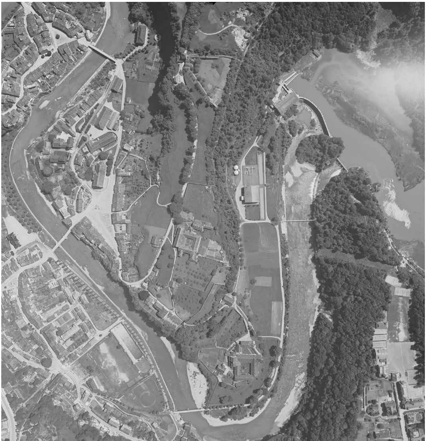
Luftaufnahme (1939). Der begradigte Lauf der Saane nach den Korrektionsarbeiten und dem Bau der Staumauer der Magerau. © Reproduziert mit Einwilligung von swisstopo (BA18046)
