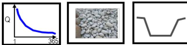
Figure 7: Icônes illustrant les différents paramètres impactant le charriage (à gauche: hydrologie; au milieu: apport en sédiment; à droite: correction du lit et des berges)
