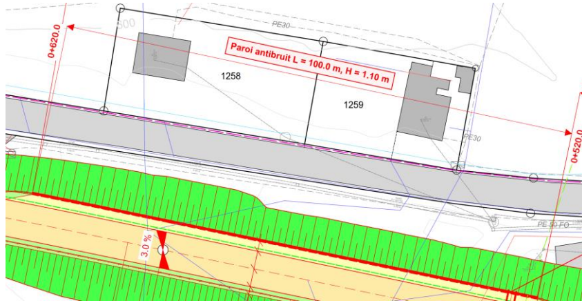
Figure 3.1 : Extrait de situation du mur km 0+520 - 0+620
