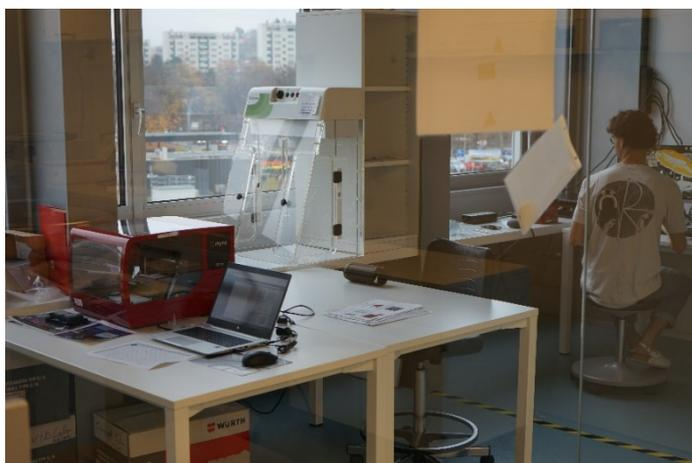
*In der Einrichtung für virologische Tests auf Covid-19 beim LSVW werden mehrere Geräte verwendet. Der rote Roboter vorne im Bild automatisiert namentlich die Reagenzvorbereitung für die Nukleinsäureamplifikation (PCR) zum Nachweis von für SARS-COV-2 spezifischen Genen.*
