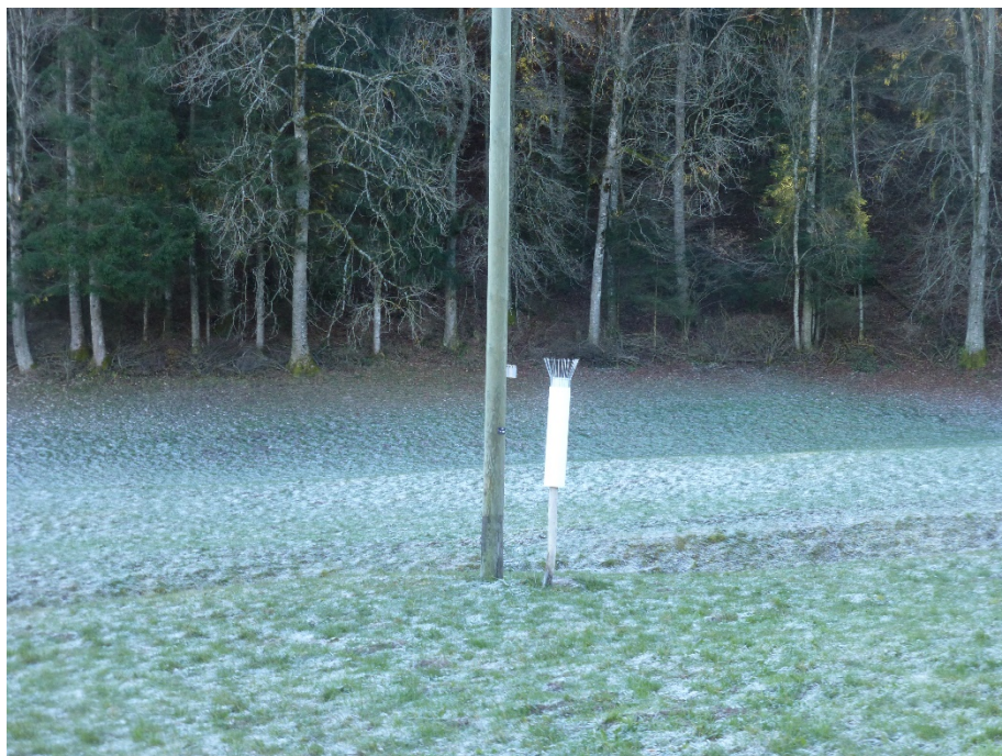
Messvorrichtung zur Bestimmung von Stickstoffdeposition in Plaffeien
