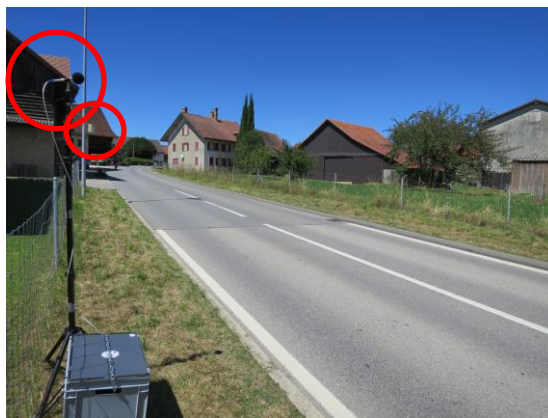
Vue point de mesurage 2 (sonomètre et compteur trafic)
