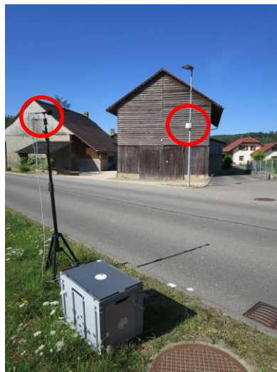
Vue point de mesurage 3 (sonomètre et compteur trafic)
