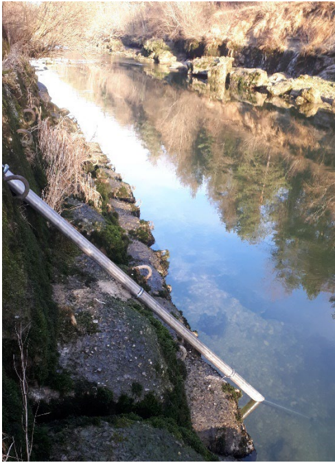
Abbildung 1: Erhebung von Daten in der Saane mit einer Sonde unterhalb der Staumauer des Schiffensees
