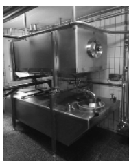
Tank sur peson (réception du lait).
