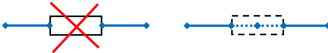
Figur 3: Ersatz eines Polygons durch einen Punkt und zwei internen Leitungen
