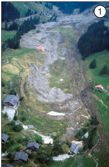
Abb. 3: Katastrophale Reaktivierung der Rutschung Falli-Höllli im Jahr 1994. Bild 1: Der Mittelteil der Rutschung reisst das aus etwa vierzig Häusern bestehende Feriendorf fort. Bild 2: Am 21. Juli 1994 verursachen die Massenbewegungen den Einsturz des Restaurants Falli-Höllli.
