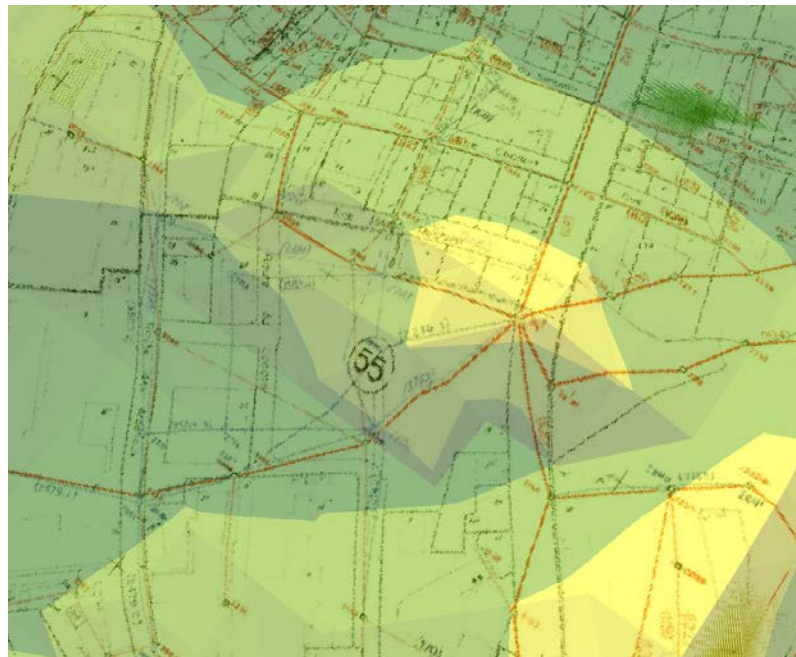
Fig. 2 : Superposition de la dérivée de l'intensité avec les canevas polygonométriques. On remarque les lignes rouges des polygonales qui convergent avers un nœud se trouvant dans une zone avec une rupture de dérivée (zone jaune).
