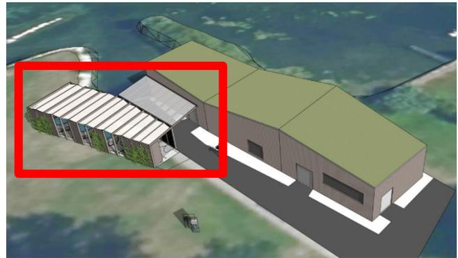
Die Notwendigkeit dieser Ergänzung ergab sich aus den besonderen Bedürfnissen der Hecht- und Forellenzucht; die Abdeckung soll die Stabilität der Wassertemperatur insbesondere bei direkter Sonneneinstrahlung ermöglichen
