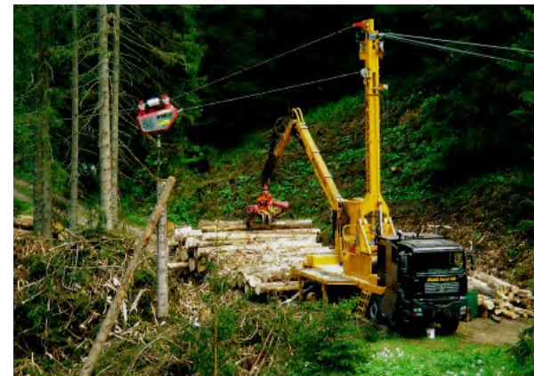
Die Verwendung eines Seilkran-Lastwagens ist im Berggebiet nur mit einer angepassten Infrastruktur möglich.
