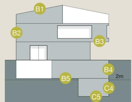
B (mur, toit, sol):  $U \leq 0.20 \text{ W/m}^2\text{K}$
