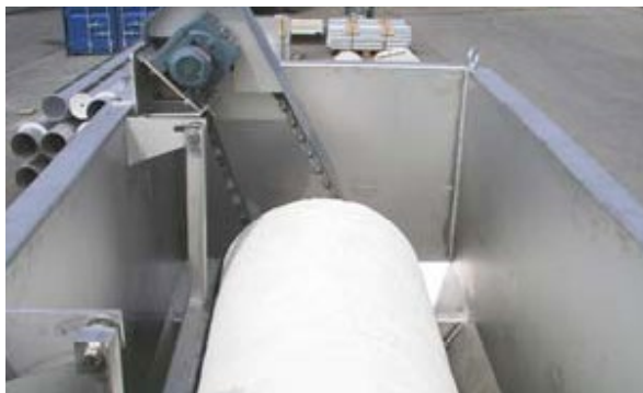
Figure 36: Filtre sur tambour (à gauche) et filtre sur disques (à droite).
