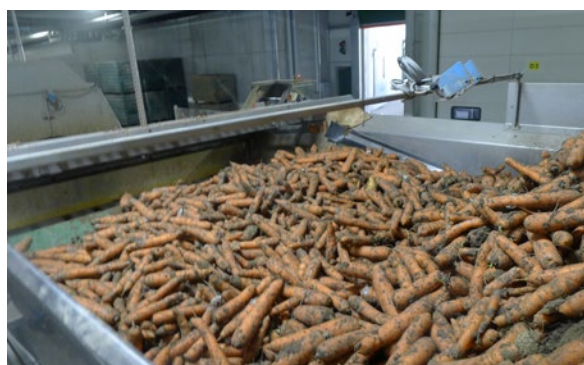
Figure 8 : Convoyeur vibrant pour retirer la terre.
