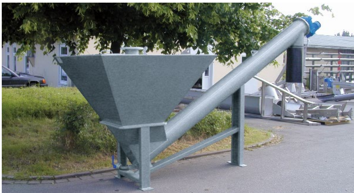
Figure 32 : Dessableur / décanteur avec évacuation à vis sans fin
