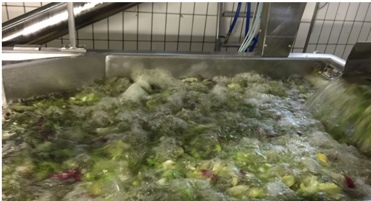
Figure 16 : Lavage de salades dans un bain équipé de buses.
