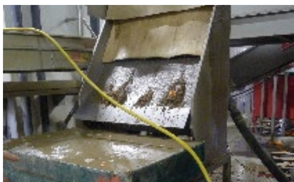
Figure 39: Tamis incurvé pour l'élimination des matières solides après le parage des carottes.
