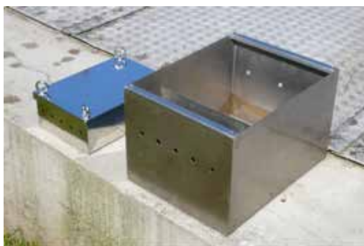
Figure 3.7 : Photos d'exemples de boîtes à sédiments. Le petit format (300 x 200 x 100 mm) sera utilisé pour échantillonner la Sarine.
