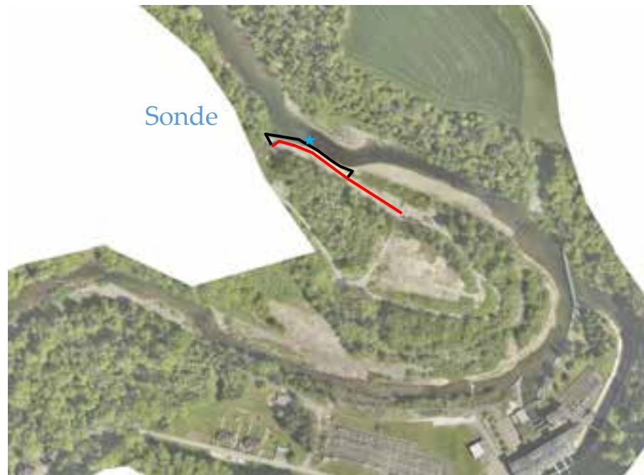
Figure 3 : Aménagements palplanche (rouge) et gabions (noir) en rive gauche de la Sarine
