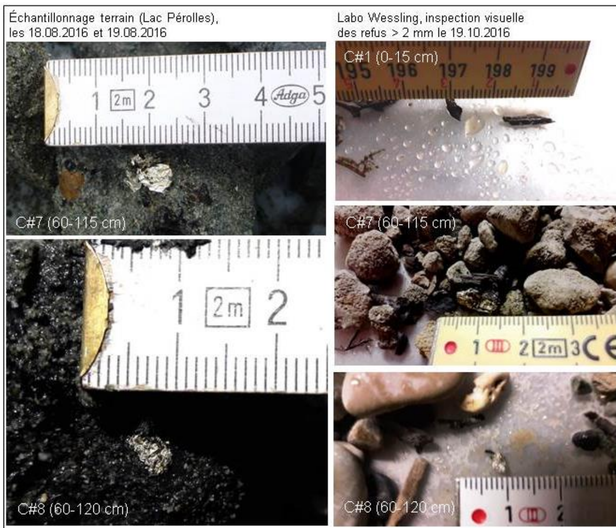
Figure 2-7 Illustrations de morceaux d'aspect métalliques observés dans les sédiments pendant l'échantillonnage (gauche) et au laboratoire après tamisage (droite).
