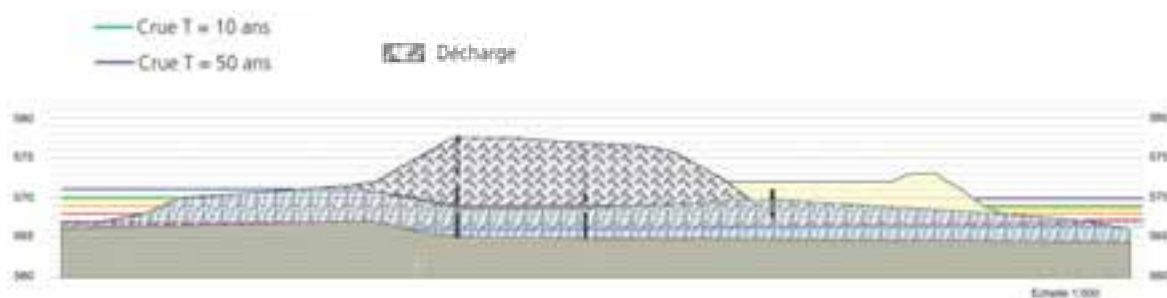
Figure 3.21 : Profil 7 : Niveau d'eau de la Sarine en temps de crue (ligne bleu foncée) et décharge
