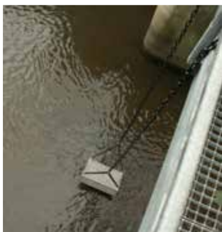
Figure 3.7 : Photos d'exemples de boîtes à sédiments. Le petit format (300 x 200 x 100 mm) sera utilisé pour échantillonner la Sarine.
