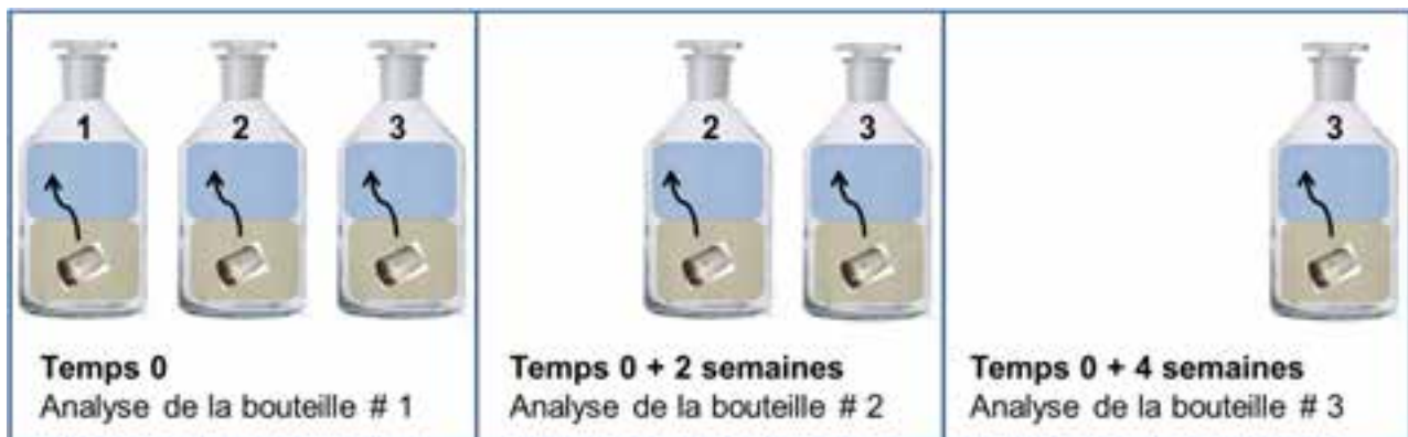
Figure 3.10 : Exemple d'essais en laboratoire visant à estimer le flux de diffusion du PCB des sédiments et/ou des condensateurs vers l'eau de la Sarine. Les intervalles de temps et le nombre d'échantillon sont à titre indicatif seulement.
