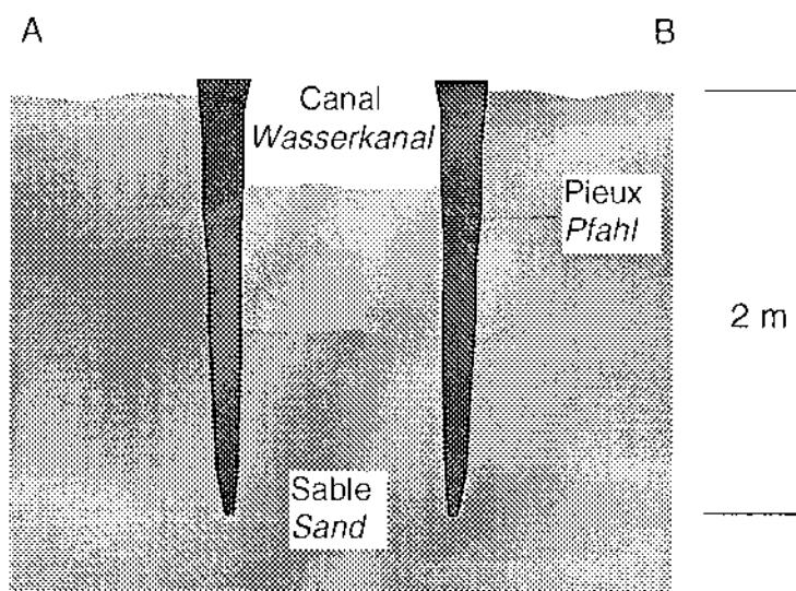
**Rétrécissement du chenal d'évacuation pour augmenter la profondeur d'eau****M 2**
