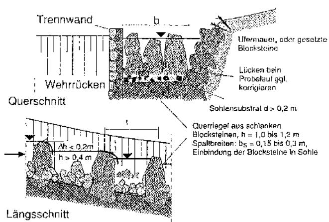
Bild 4.31: Rauhgerinne-Beckenpaß (Gerinnequerschnitt und Längsschnitt)
