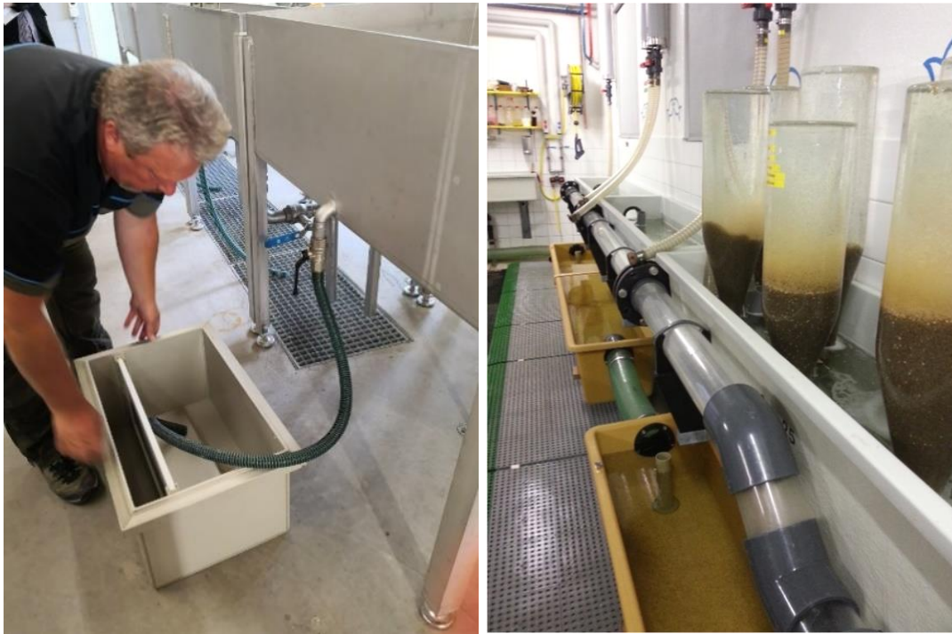
Figure 15 Bac de collecte des larves à Estavayer et système de collecte typique
