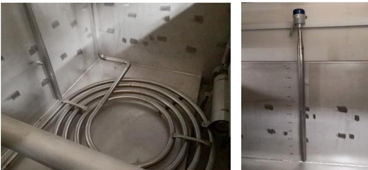
Figure 5 Chauffage de l'eau
