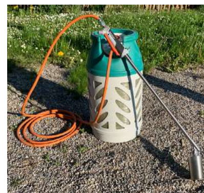
Brûleur à gaz
