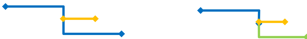
Figure 4 : Section en deux de la conduite bleue pour intersection avec la conduite jaune
