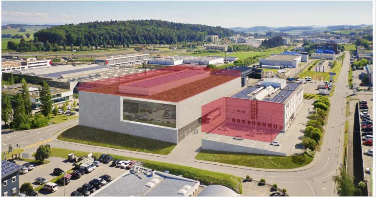
Potentiel d'extension (en rouge) d'un étage sur le bâtiment du SIC et de trois niveaux sur le futur parking.
