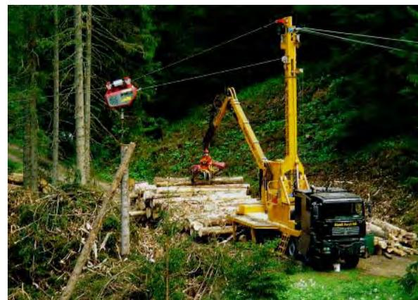
*L'utilisation d'un camion câble-grue en montagne n'est possible que si les infrastructures sont développées de façon adéquate.*
