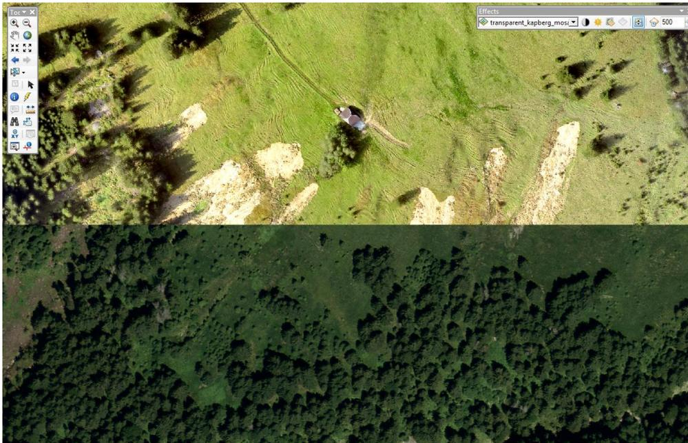
Figure 20 : Comparaison entre l'orthophoto prise par le drone (en haut) et l'orthophoto Swisstopo de 2010 (en bas).
