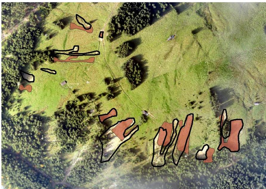
Figure 19 : Orthophotos obtenues à partir d'un vol de drone. Les surfaces brunes montrent les surfaces StorMe (cartographie de terrain avec données SIG standards). Les traits noirs montrent les surfaces réelles de ces glissements.
