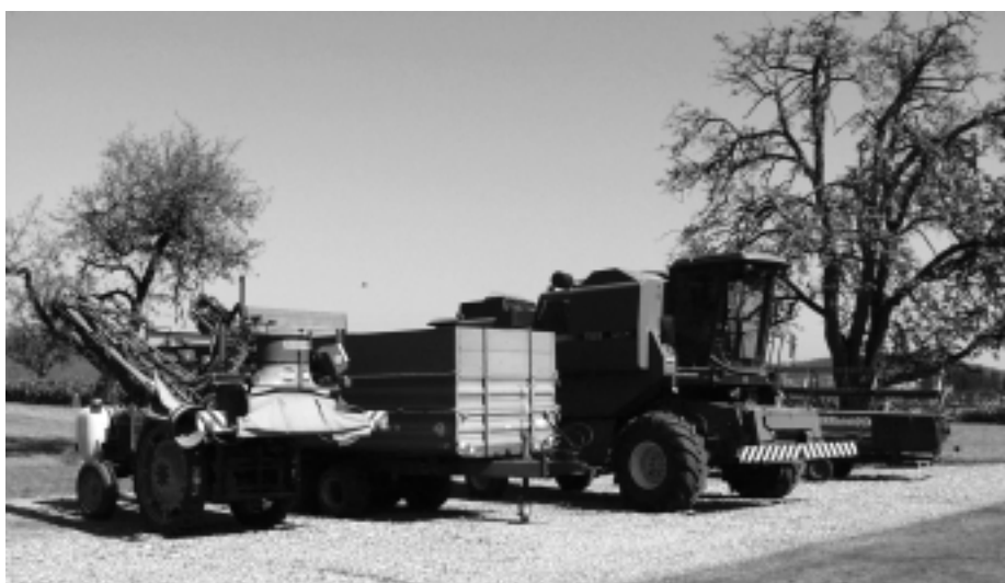
Fig. 10: Lorsque les machines sont rangées à l'extérieur, l'exploitation économise le coût des bâtiments. Toutefois, on constate plus fréquemment des dommages dus à la corrosion sur les machines.
